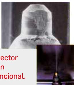
Aspecto de un inyector en contacto con un carburante convencional.
