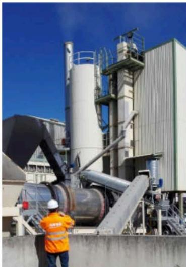
Figura 5: Conducto para extracción adicional de aire caliente del tambor secador en una central discontinua
