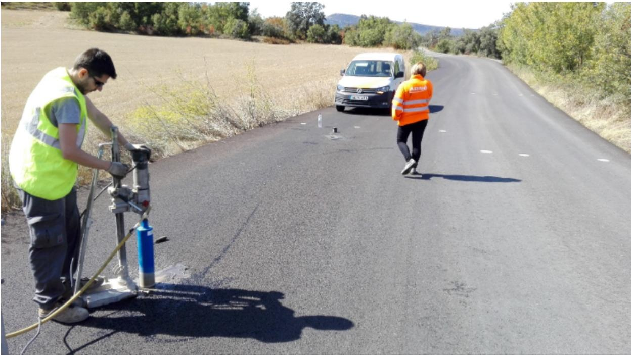
Figura 9: Extracción de testigos para la medida de la textura de las mezclas
