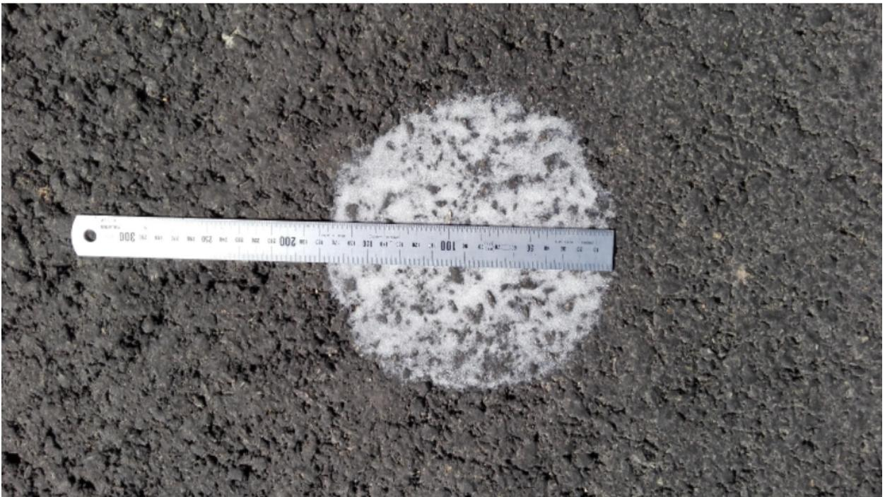
Figura 10: Detalle de la medida del círculo de arena
