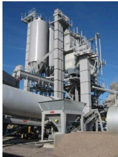
Figura 6: En primer término, tolva para la incorporación de una fracción de material fresado, a temperatura ambiente, directamente a la mezcladora.
