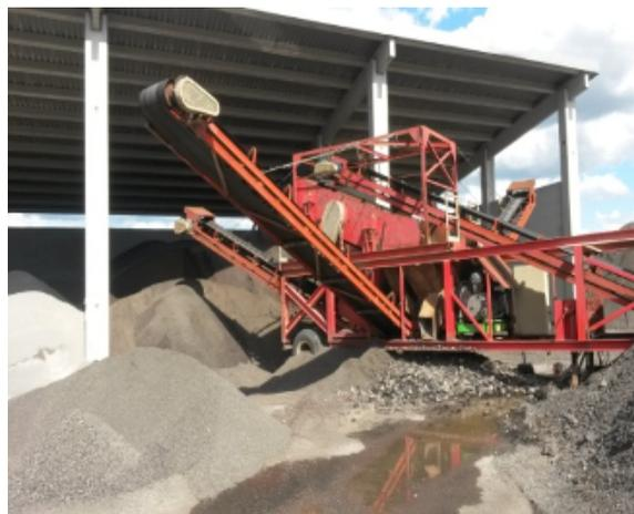
Figura 1: Clasificación del material de fresado.
